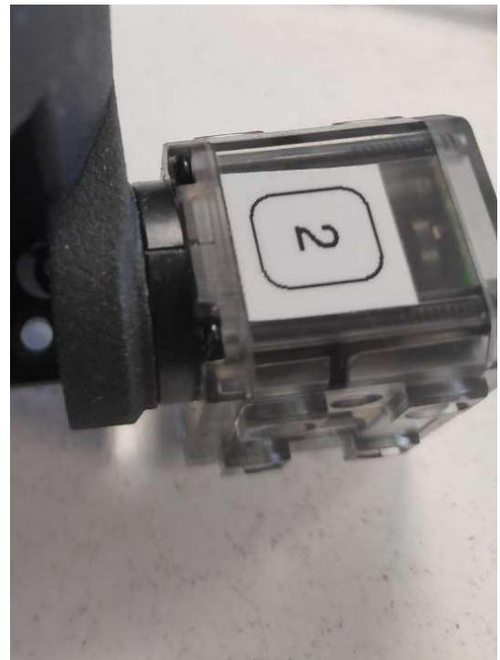
Con el servo alineado, colocarlo en la siguiente posición con respecto a la cámara y atornillar sin apretar demasiado (es plástico).
