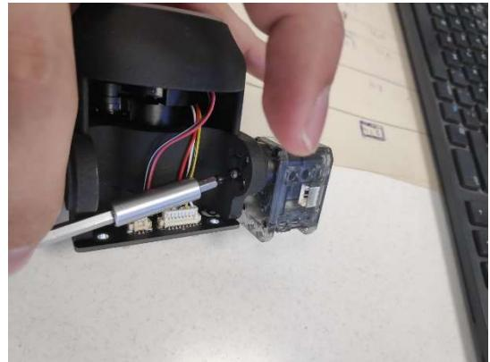
Antes de montar el servo nuevo, es necesario alinear las dos marcas del servo tal y como se indican en la figura. Prestar especial atención a este paso ya que el servo contiene dos marcas fácilmente confundibles, una marca simple (una línea) y una doble (dos líneas). Es necesario alinear la marca simple con la línea de la carcasa del servo.
